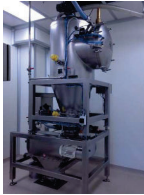
Abscheider mit großer Filterfläche
