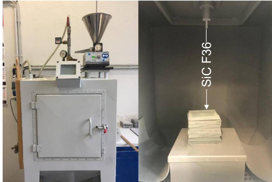
Klassische Erosion nach ASTM C704-15 ( \text{cm}^3 )
