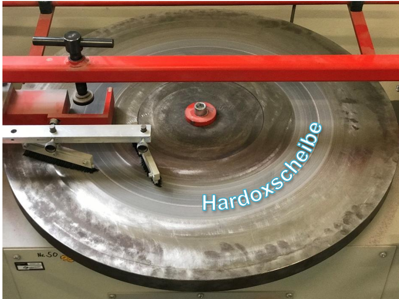
Klassische Abrasion nach DIN 52108 ( \text{cm}^3/50\text{cm}^2 )
